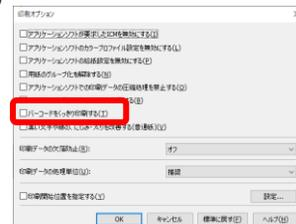
\*バーコードモードは、片方向での印字になるため双方方向印字の約2倍の印刷時間がかかります
