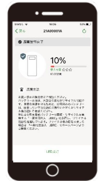
SOC : State of Chargeの略、使用できるバッテリーの充電率を表します
